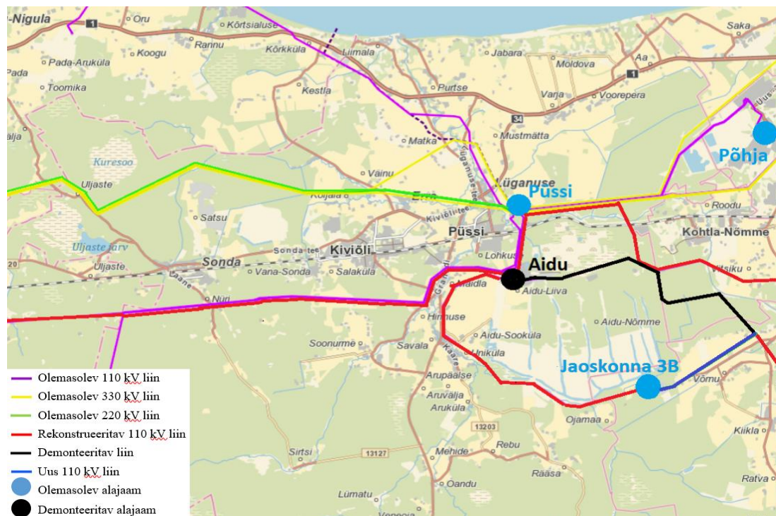
Skeem 3. Elering AS 110 kV elektrivõrgu ümberkorraldamine Lüganuse vallas
