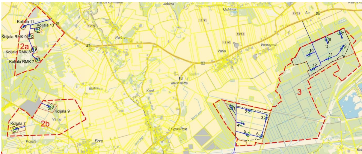
Joonis 4.2. Eriplaneeringu põhilahendus alal 2a ja 2b ning 3, kus punane kriipsjoon tähistab eelvaliku ala piiri, punane pidevjoon planeeritud krundi piiri, roheline kriips-punktjoon illustreerivat põhimõttelist tuuliku asukohta, must kriips-punktjoon krundi hoonestusala, sinine pidevjoon põhimõttelist juurdepääsuteed.
