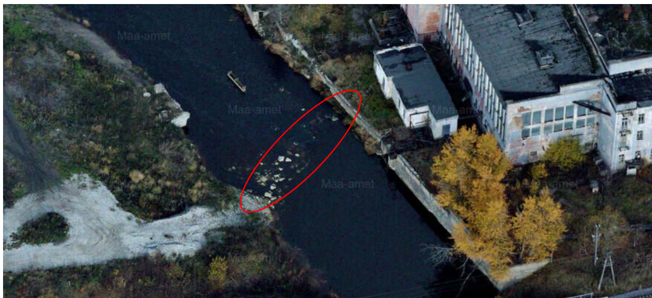
Foto 2. Repo Vabrikud AS veehaarde toimimiseks vajalik paisutus, mis rajati Püssi paisjärve reostuse ohutustamistööde käigus 2020. aastal (Maa-amet, fotoladu, pildistamise aeg 24.10.2022).
